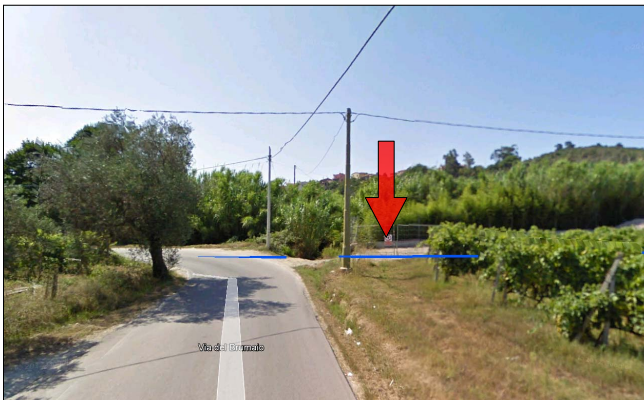
Figura 2.4 – Zona della Pila non arginata: eventuali volumi liquidi esondati provenienti da monte (a sinistra nella foto), possono rientrare in questo tratto all'interno del corso d'acqua, indicato in blu sullo sfondo
